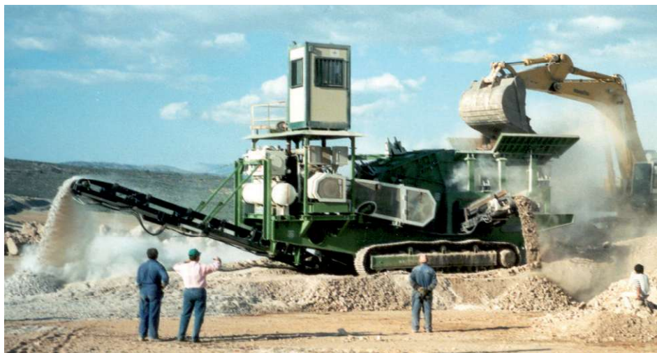
Abb. 10 Planox®-Kupplung PMA-HR 183/0 kombiniert mit einer Voith-Turbo-Kupplung 650 TG in einer der größten mobilen Brecheranlagen, Motorleistung P = 550 kW bei n = 2100 min -1 .
