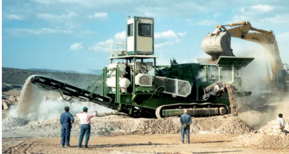
Abb. 10 Planox®-Kupplung PMA-HR 183/0 kombiniert mit einer Voith-Turbo-Kupplung 650 TG in einer der größten mobilen Brecheranlagen, Motorleistung P = 550 kW bei n = 2100 min -1 .
